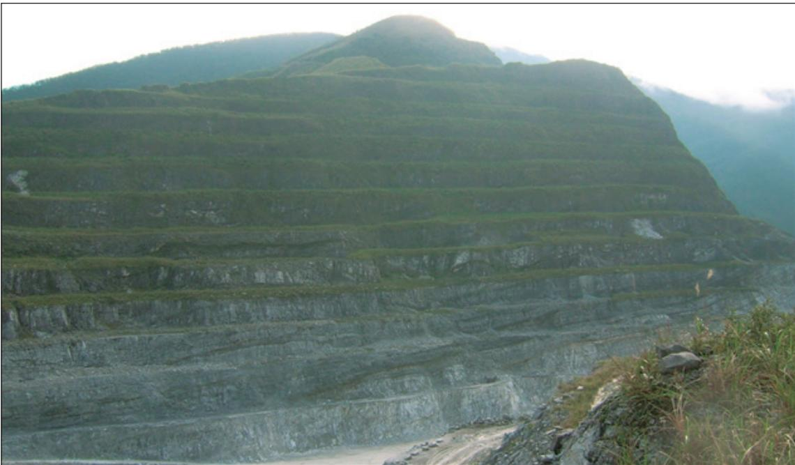
採礦工法：階段採掘法
